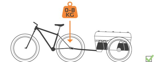
Eine **optimale** Stützlast ermöglicht ein sicheres Fahrverhalten.
