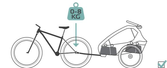
Eine **optimale** Stützlast ermöglicht ein sicheres Fahrverhalten.
